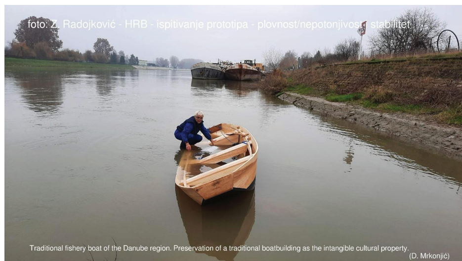
Slika 7: Ispitivanje prototipa – plovnost, nepotonjivost stabilitet.
